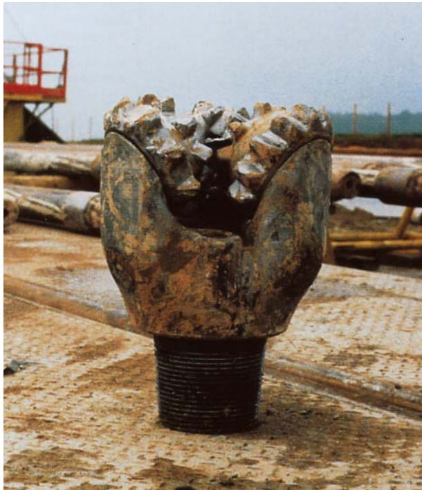
Der Rollen-Meißel. Er eignet sich zum Bohren in eher weichen Gesteinsarten. Auf drei radial angeordneten Rollen sind Zähne aus speziell hartem Stahl angebracht, die das Gestein zertrümmern.
