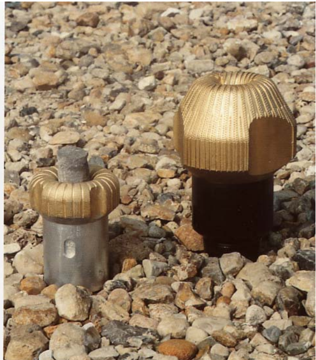
Der Diamant-Meißel. Er eignet sich für hartes Gestein. Der Bohrkopf ist mit künstlich hergestellten Diamanten besetzt. Er ist sehr teuer, zeigt aber einen relativ geringen Verschleiß.
