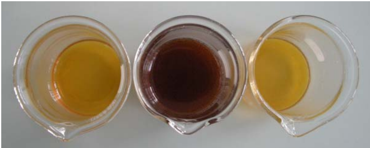
Abbildung 3: Reaktionskomplex des Katalysators, wenn er an der "Arbeit" ist. Katalysatorlösung 0.1 mol/l \text{FeCl}_3 , links: reine Lösung, Mitte: zusammen mit \text{H}_2\text{O}_2 beim reagieren, rechts: nach der Reaktion.
