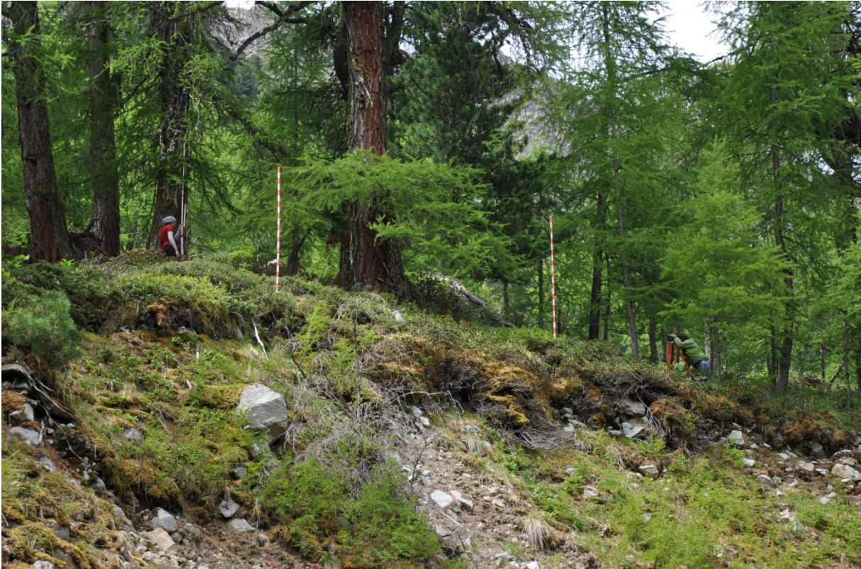
Abb. 5 Nivellierzug im Wald. Das Resultat sind die Höhenlinien in der Abb. 7.
