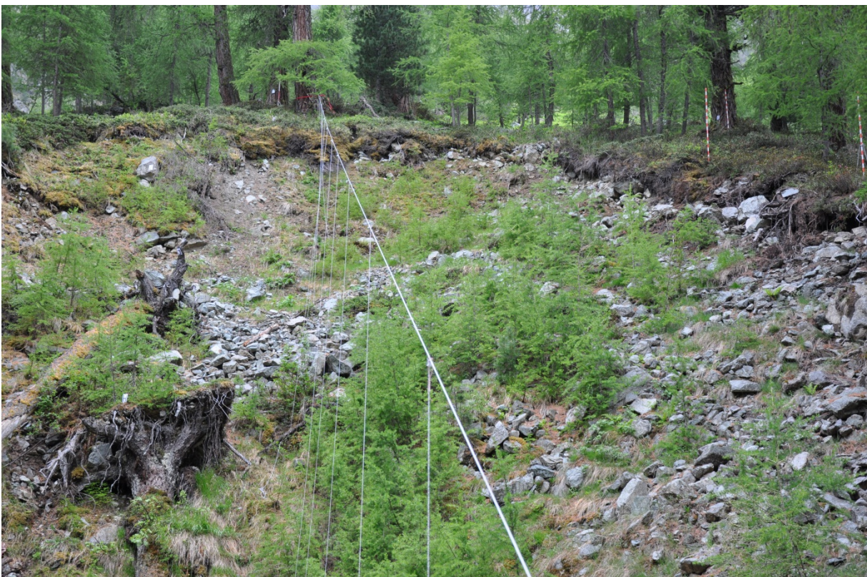
Abb. 6 Seilkonstruktion zur Vermessung des Geländeprofiles in der Falllinie. Das obere Seilende ist im Punkt B2 befestigt. Resultat ist dargestellt in der Abb. 8.
