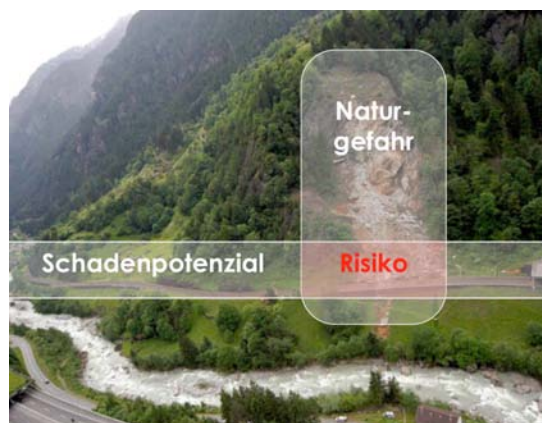
Das Naturrisiko ist das Produkt aus Naturgefahr und Schadenpotenzial. Hier dargestellt am Beispiel des Felssturzes in Gurnellen (Bild: drs.srf.ch)
