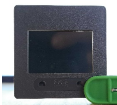
Gekreuzte Polarisationsfilter ohne Lösung im Lichtweg: Licht wird blockiert
