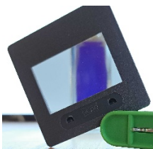
Fructoselösung: Polarisationsfilter 2 wird gedreht, bis das Licht wieder maximal blockiert wird.
