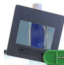
Glucoselösung: Polarisationsfilter 2 wird gedreht, bis das Licht wieder maximal blockiert wird
