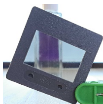
Saccharoselösung: Polarisationsfilter 2 wird gedreht, bis das Licht wieder maximal blockiert wird.
