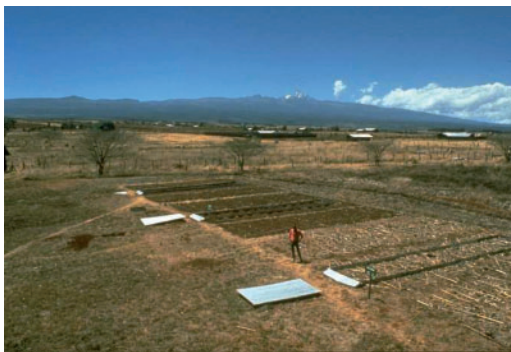
Bild 1: Testfelder zur Messung der Bodenerosion
