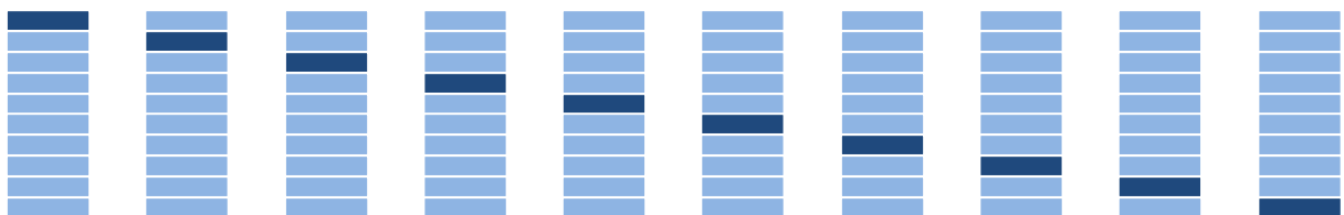
Abbildung 2-1: Vorgehen bei der 10-Fold Crossvalidation (dunkelblau = Testdaten | hellblau = Trainingsdaten)
