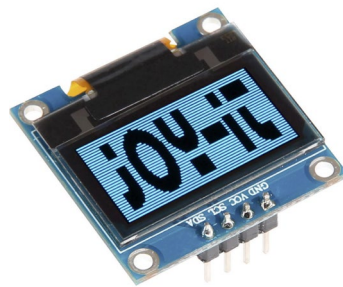
Abbildung 11 OLED Display mit 128 x 64 px, 0.96"
