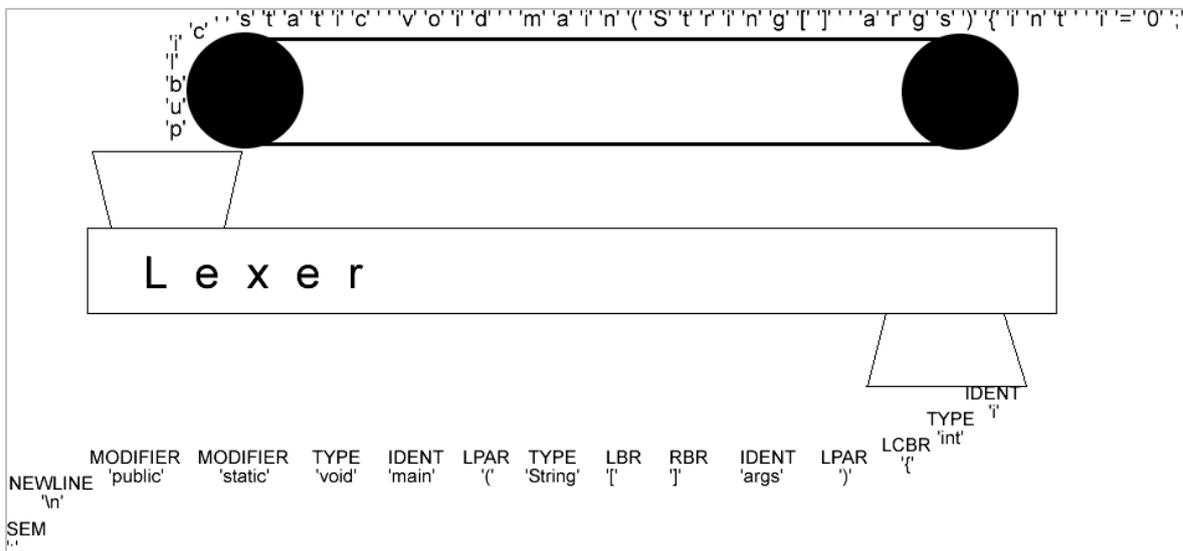
Durch die lexikalische Analyse wird eine Folge von Eingabezeichen in atomare Einheiten transformiert. Ein Token umfasst all diejenigen Zeichen, die in der anschliessenden Syntaxanalyse als gleich angesehen werden (man spricht auch von syntaktischen Kategorien).
